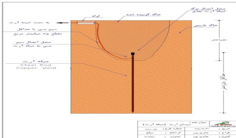
۱,۴,۴,۵. مقاومت زمین سیستم ارت اجرا شده با استفاده از توشیع دستگاه اندازه‌گیری مقاومت زمین به روش متداول سه الکترودی اندازه‌گیری شود. مقاومت اهمی زمین با استفاده از حداکثر ۳ اهم باشد.
